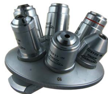
Objektivrevolver mit parfokalen Objektiven
