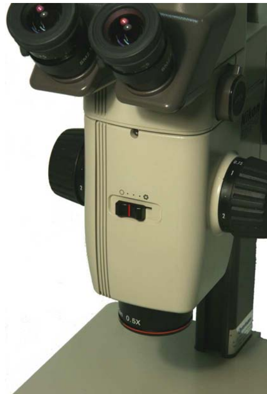
Stereomikroskop mit einer gemeinsamen Frontlinse sowie einer Aperturblende
