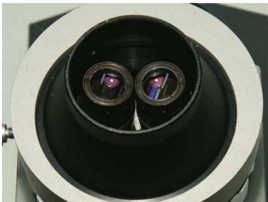
getrennte Objektive eines Stereomikroskops
