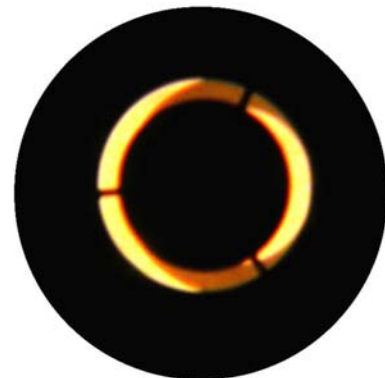
Abbild der Ringblende und des verschobenen Phasenringes in der hintere Brennebene
