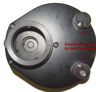
Scheibenkondensator mit Phasenring
