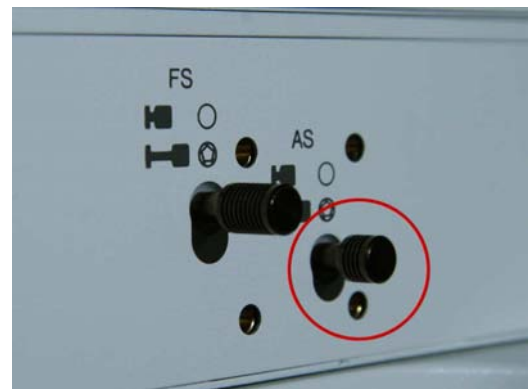
Blenden im Fluoreszenzaufsatz FS = Feldblende AS = Aperturblende
